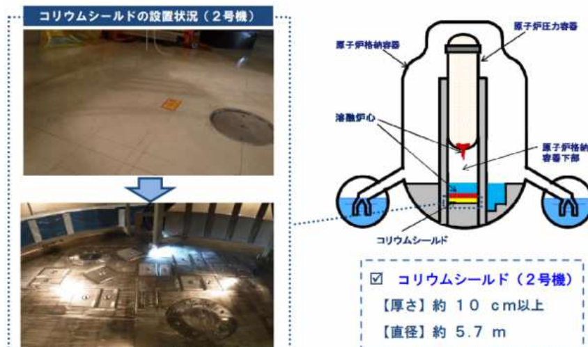
図 4.5 コリウムシールドの概念図
