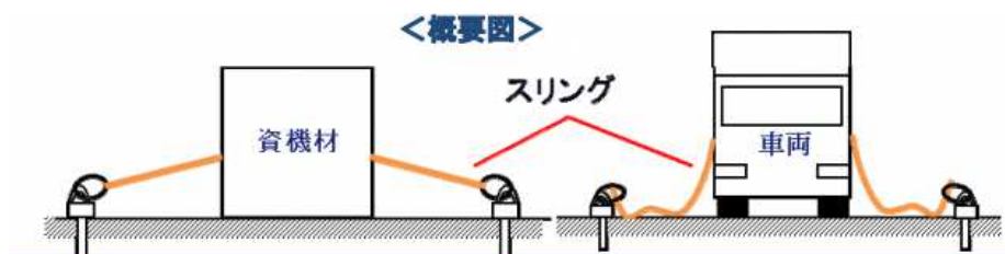
図29 車両等の固縛のイメージ
