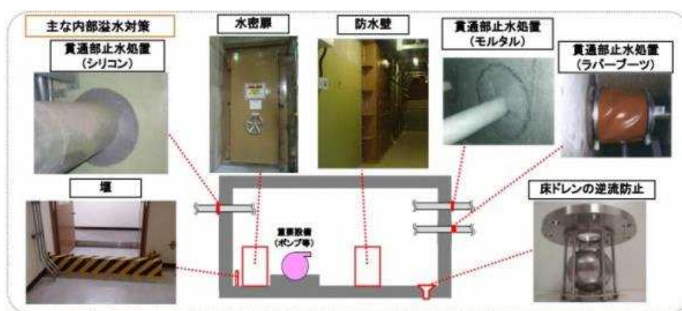
図32 溢水防護対策の例
