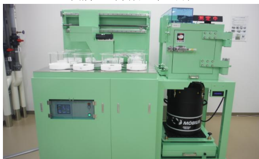
サンプルチェンジャー付ゲルマニウム半導体検出器
