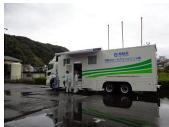
（ホールボディカウンタ車での内部被ばく検査）
