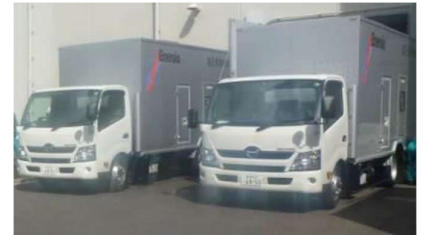
高圧発電機車
