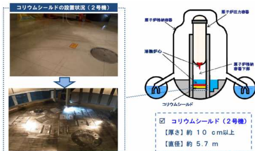
図 4.5 コリウムシールドの概念図
