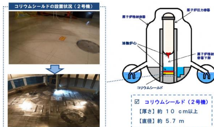
コリウムシールドの概念図
