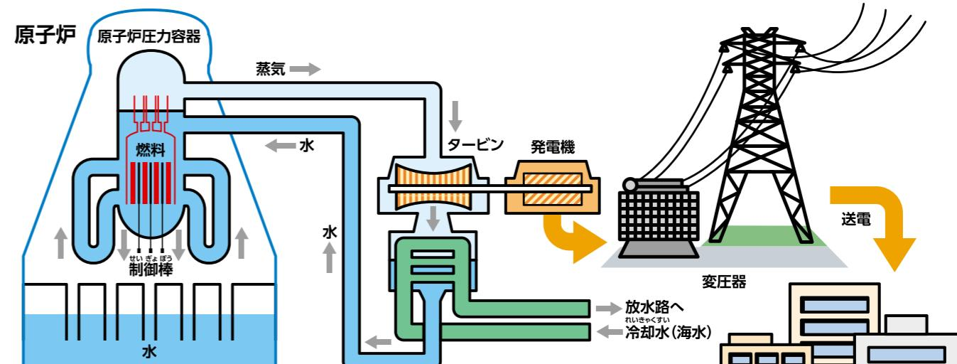
原子力発電所では、原子炉の中で燃料であるウランを核分裂させ、その時に発生する熱で水を沸騰させて蒸気をつくり、タービンを回して発電機により電気をつくります。島根県松江市に島根原子力発電所があります。
