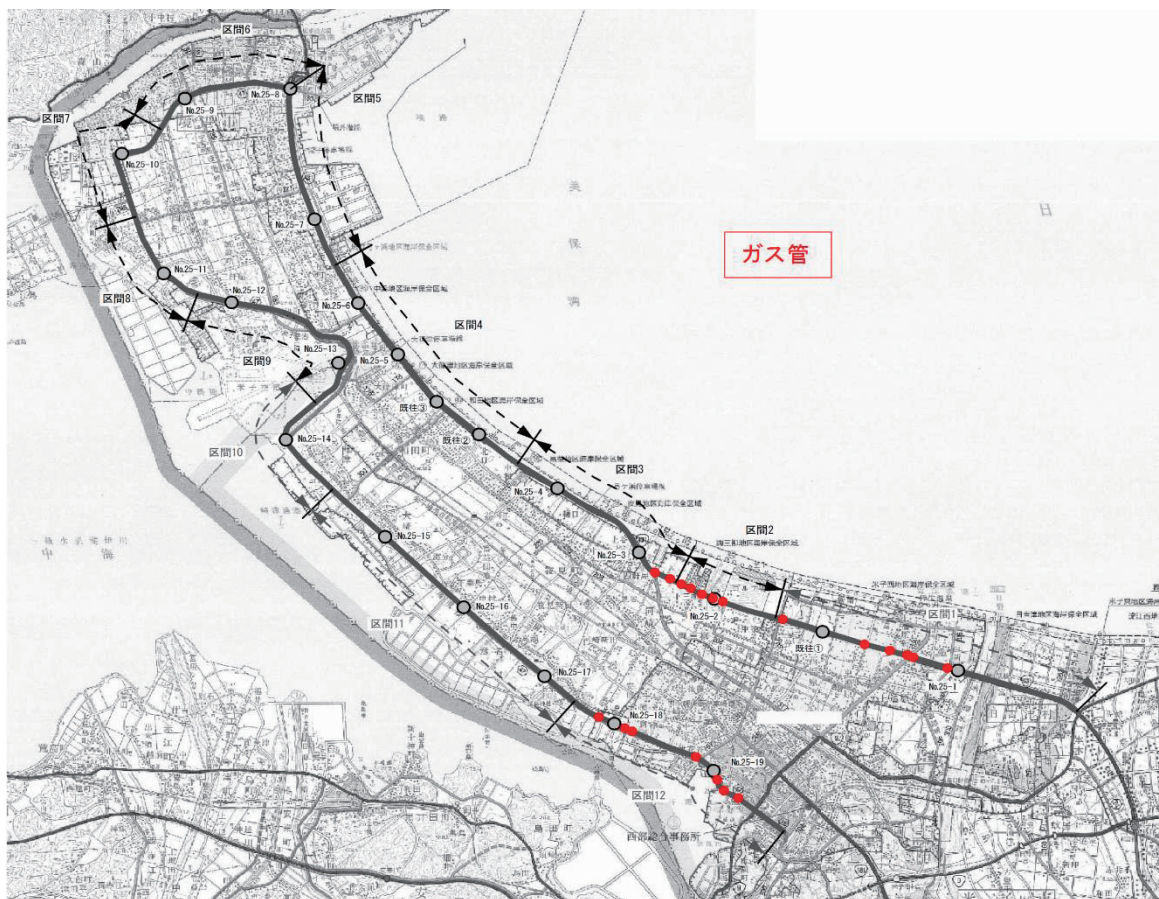
図10 ガス管（道路横断箇所）
