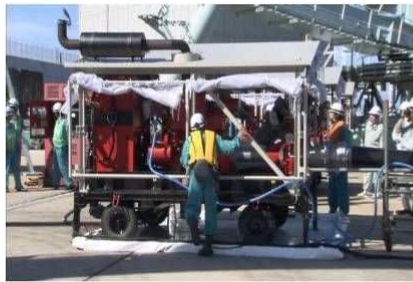
移動式ディーゼル駆動ポンプを用いた代替送水訓練の様子
