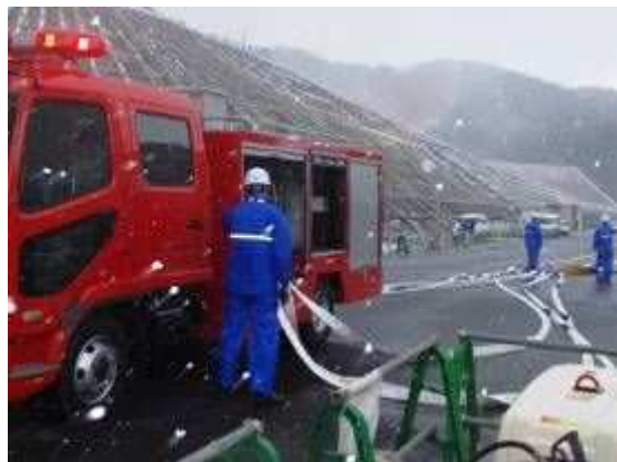
▲ 消防ポンプ車等を用いた原子炉注水訓練
