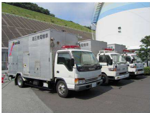
[写真] 高圧発電機車
